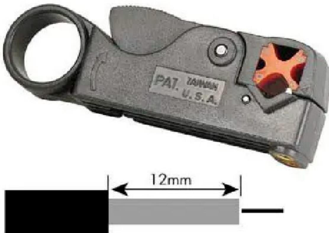
Spelafili per cavi coassiali tipo RG58 / RG59 / RG62 / RG6 / 3C2V. Agisce su cavi di diametro compreso tra 4mm e 12mm senza dover cambiare lama. Permette con una semplice rotazione attorno al cavo di spelarlo lasciando intatta la calza, eliminando guaina esterna e isolante interno. Dispone di due lame e attraverso una chiave a brugola in dotazione, è possibile variare la profondità di taglio effettuato. Strumento semplice da usare e di alta qualità, essenziale nelle
