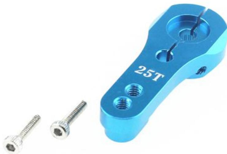
Squadretta in alluminio per servo RC con attacco 25T (Futaba, savox, Xcore, HL, HSP, HD power, Go tech) e fori filettati. Dimensioni (mm): 35,4x14,75x6, peso: 4,3 grammi. Compatibile con i servo RC MG995, MG946R, MG996R, MG945, S3003 (vedere prodotti correlati).
