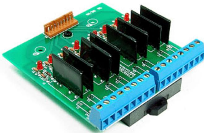
Scheda dotata di 8 relè allo stato solido che permette di controllare, tramite i moduli CUBLOC e CUTOUCH, l'attivazione/disattivazione di dispositivi funzionanti con tensioni massime di 30 Vdc o 240 Vac. La scheda può essere alimentata con una tensione compresa tra 4 e 32 Vdc, assorbimento massimo 2 A, dimensioni 88 x 85 x 25 mm, attacco con guida DIN. La scheda dispone di funzione Plug-N-Play quando viene connessa alle schede CuBASE o CuTOUCH.
