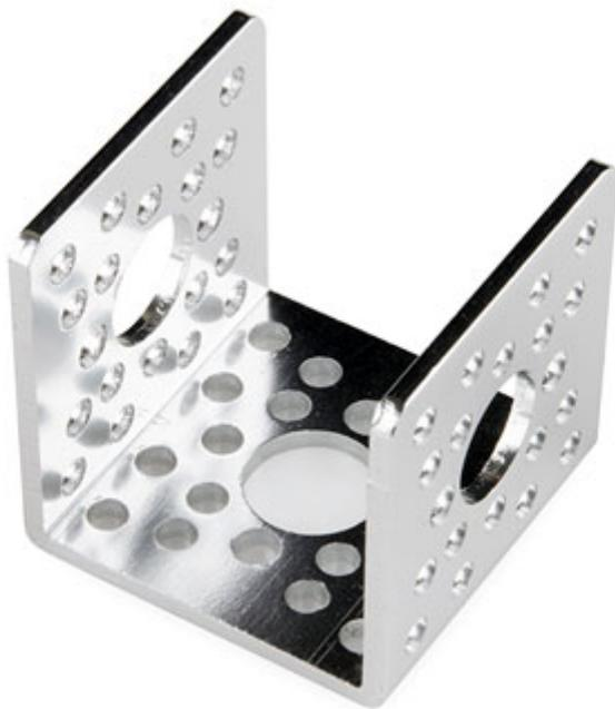
Leggera e robusta staffa a "U" realizzata in alluminio anodizzato da 2,2 mm. Dispone di 21 fori su ogni faccia (20 da 3,5 mm e 1 da 12,5 mm) e permette di creare strutture meccaniche per varie applicazioni. La confezione comprende 1 staffa.
