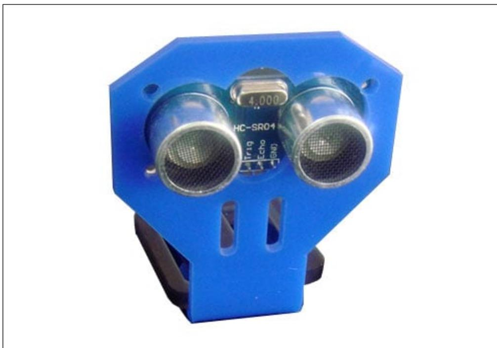
Realizzata in acrilico, questa staffa permette di montare in modo semplice e veloce il sensore ad ultrasuoni MISDIST04 o MISDIST05. Spessa circa 3 mm, dispone frontalmente di quattro fori da 3 mm per il fissaggio del sensore alla staffa, mentre sul fondo ha tre fori che possono essere utilizzati per montare la staffa ad un servo RC. La confezione comprende solo la staffa. **N.B.** il sensore ad ultrasuoni non è compreso.
