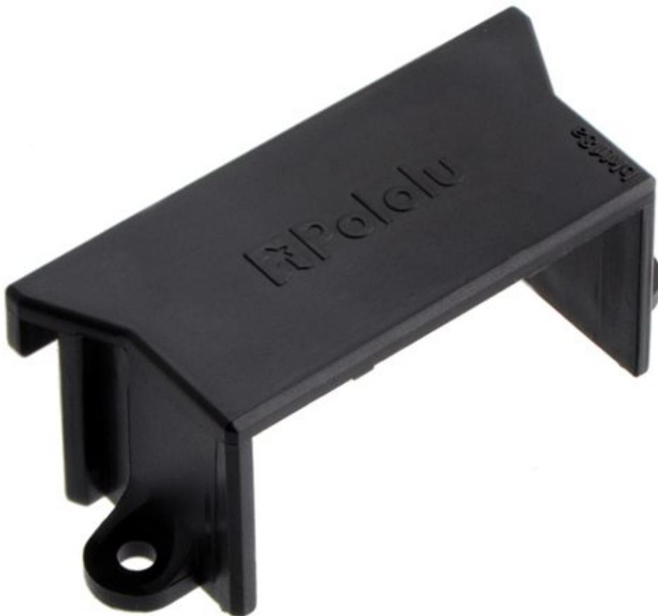
Staffa di montaggio in plastica realizzata appositamente per essere utilizzata con servi di dimensioni standard (larghezza max. 40,7 mm e altezza 20 mm – vedere prodotti correlati). Fornisce un modo semplice per montare un servo su un lato. I fori di montaggio sulla staffa sono destinati all'uso con viti M3 (non incluse).
