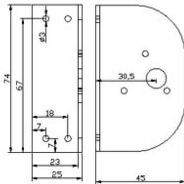
Staffa di supporto per il montaggio del motoriduttore EMG30 al robot. La staffa è in alluminio con uno spessore di 2 mm ed è rifinita in smalto blu.
