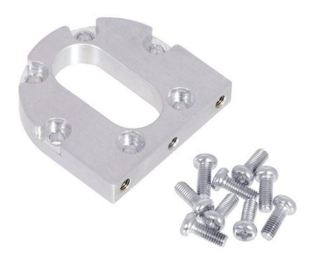
Leggera e robusta staffa in alluminio lavorato che permette di montare in modo sicuro un motoriduttore. Frontalmente dispone di sei fori per il montaggio del motoriduttore alla staffa, mentre sul fondo ha tre fori filettati M3 che possono essere utilizzati per montare il motoriduttore su una superficie. La confezione comprende la staffa e nove viti M3 da 8 mm.
