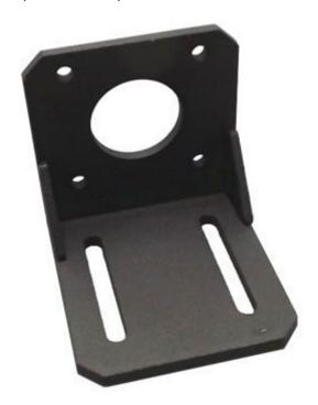
Realizzata in ferro verniciato di nero, questa robusta staffa a "L" permette di montare in modo semplice e veloce un motore passo-passo NEMA17. Spessa 3 mm, dispone frontalmente di quattro fori da 3 mm per il fissaggio del motore alla staffa, mentre sul fondo ha due asole larghe 4,2 mm e lunghe 34 mm, che possono essere utilizzate per montare il motore su una superficie. La confezione comprende solo la staffa. N.B. il motore passo-passo NEMA17 non è compreso.
