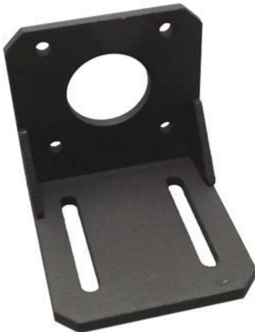
Realizzata in ferro verniciato di nero, questa robusta staffa a "L" permette di montare in modo semplice e veloce un motore passo-passo NEMA23. Spessa 3 mm, dispone frontalmente di quattro fori da 5 mm per il fissaggio del motore alla staffa, mentre sul fondo ha due asole larghe 4,2 mm e lunghe 45 mm, che possono essere utilizzate per montare il motore su una superficie. La confezione comprende solo la staffa. N.B. il motore passo-passo NEMA23 non è compreso.
