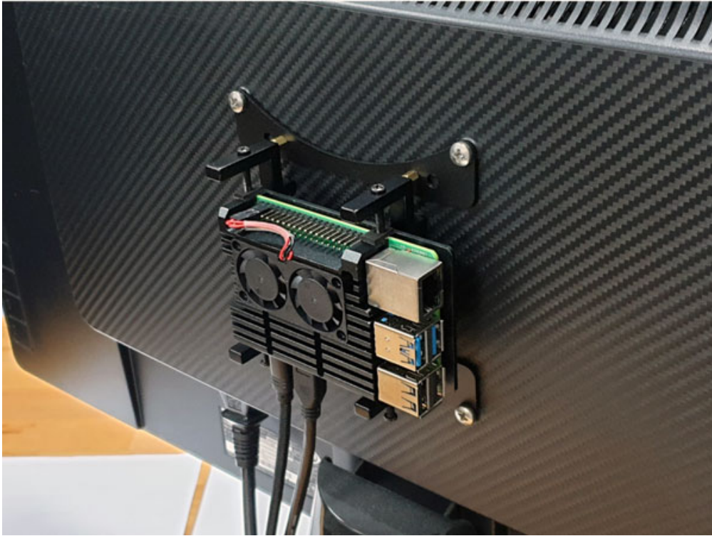
La Staffa montata sul retro di un TV standard VESA
