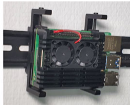
La Staffa montata su guida DIN
