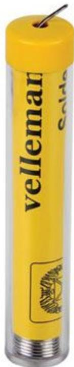
Dispenser con filo di stagno per saldatura diametro 1 mm e 17 grammi di peso. Lega composta dal 60% di stagno e 40% di piombo, anima con flussante, punto di fusione 185°C.
