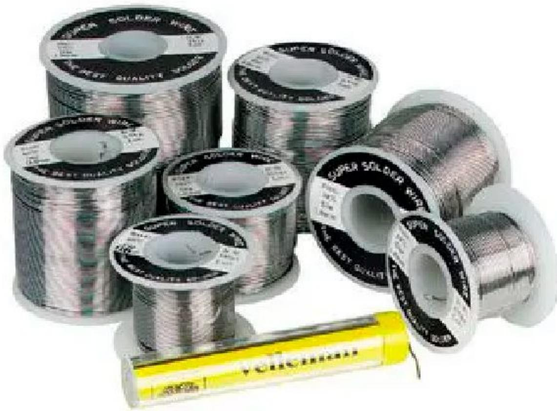
Bobina da 500 grammi di filo di stagno del diametro di 1 mm con anima di flussante. Lega 60% Sn - 40% Pb, punto di fusione 185
