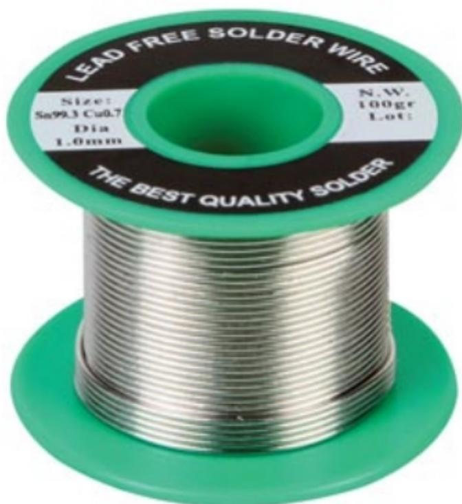
Rocchetto di stagno per saldatura del peso di 100 grammi con filo diametro 1 mm "lead-free" ovvero senza piombo. Lega composta dal 97% di stagno e 3% di rame, anima con flussante, punto di fusione 230 °C
