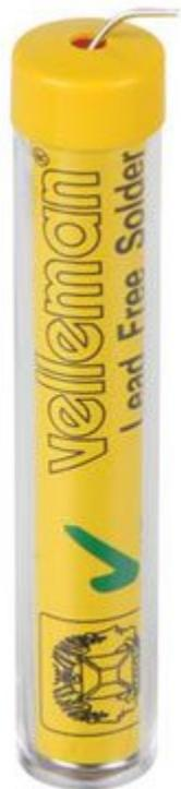
Confezione di stagno per saldatura del peso di 15 grammi con filo diametro 1 mm "lead-free" ovvero senza piombo. Lega composta dal 99,3% di stagno e 0,7% di rame, anima con flussante, punto di fusione 230°C. Confezione con dispenser.
