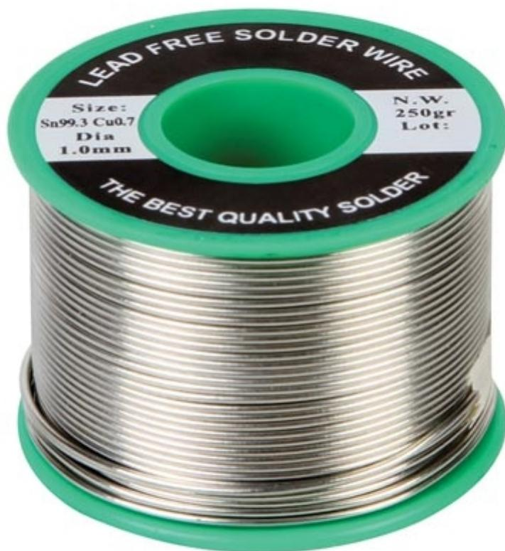
Rocchetto di stagno per saldatura del peso di 250 grammi con filo diametro 1 mm "lead-free" ovvero senza piombo. Lega composta dal 99,3% di stagno e 0,7% di rame, anima con flussante, punto di fusione 230
