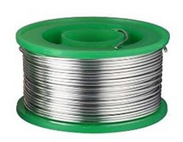
Rocchetto di stagno per saldatura del peso di 100 grammi con filo diametro 0,8 mm. Lega composta dal 63% di stagno e 37% di piombo, anima con flussante, punto di fusione 185°C.
