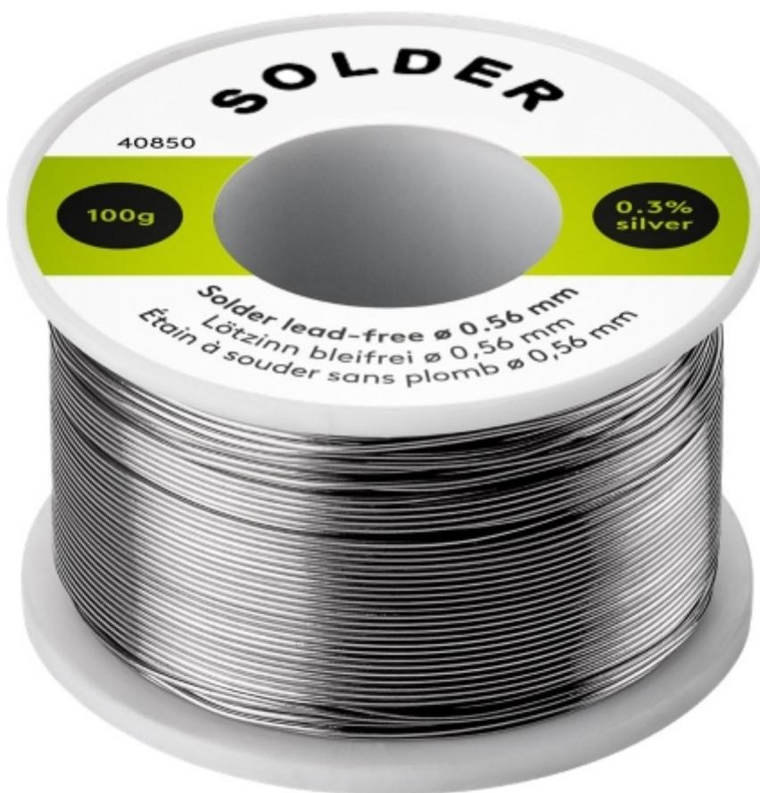
Rocchetto di stagno per saldatura del peso di 100 grammi con filo diametro 0,56 mm "lead-free" ovvero senza piombo. Lega composta da 0,3 % argento, 0,7 % rame, 96,5 % stagno; 2,5 % fluxante; punto di fusione: 217° C. Rispettoso dell'ambiente aumenta la conducibilità elettrica
