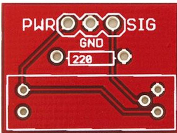
Circuito stampato realizzato appositamente per il photo interruttore a forcina GP1A57.
