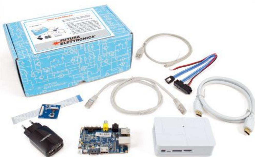
Contiene tutto il necessario per imparare a programmare e realizzare applicazioni elettroniche con la scheda Banana Pi. La confezione comprende la scheda Banana Pi, la telecamera per Banana Pi, il contenitore BANANAPIBOX, cavo HDMI lungo 1,5 metri, cavo USB M(A) / Micro(B) lungo 0,7 metri, cavo FTP CAT5E lungo 0,75 metri, cavo SATA per Banana Pi lungo circa 30 cm e un alimentatore switching 2 uscite USB - 5 Vdc / 3,1 A.
