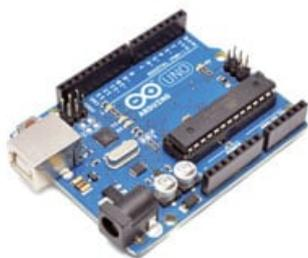
1 Pz - Scheda ARDUINO UNO Rev 3 con ATmega328 - completamente assemblata e testata.
