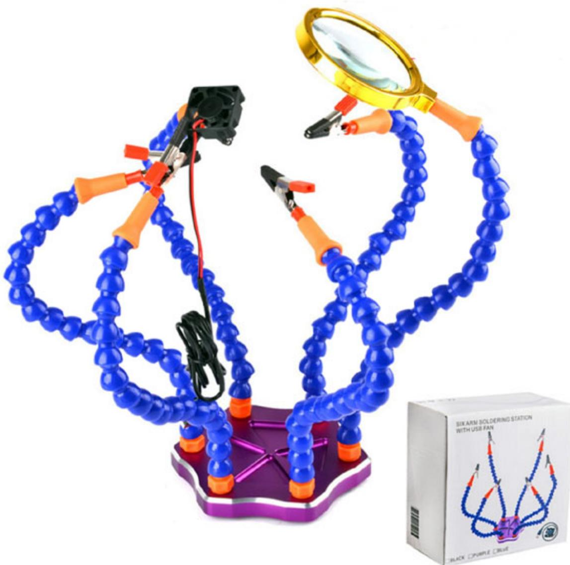
Stazione di lavoro per saldatura composta da 6 bracci flessibili, lente d'ingrandimento 3x, ventola 30x30 con alimentazione USB e 6 clip a coccodrillo. Permette di sorreggere piccoli oggetti e di avere entrambe le mani libere. La ventola consente di assorbire il fumo della saldatura, mentre le clip a coccodrillo e la lente d'ingrandimento orientabile, consentono di realizzare, con estremo confort, lavori di precisione.
