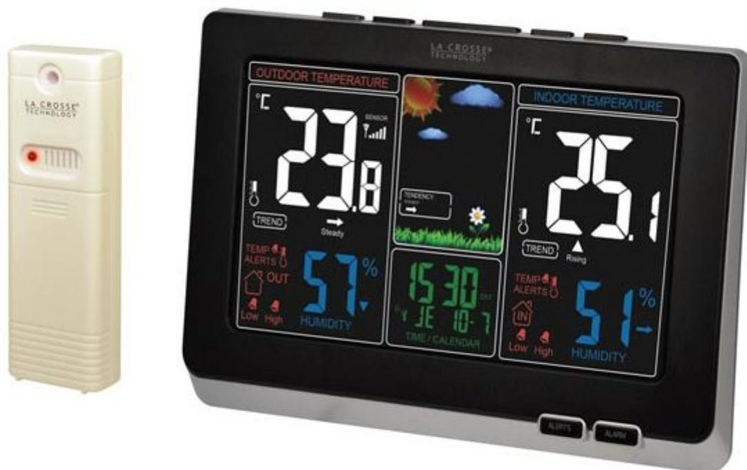
Stazione meteorologica wireless con data e orario radiocontrollato tramite segnale DCF composta da un'unità base da un sensore di temperatura/umidità da esterno. Visualizza su display LCD l'ora, la data, la temperatura interna/esterna e l'umidità interna/esterna. Memorizzazione dei valori minimi e massimi rilevati; distanza di trasmissione 90 m circa (in campo aperto). Montaggio a parete o su scrivania.
