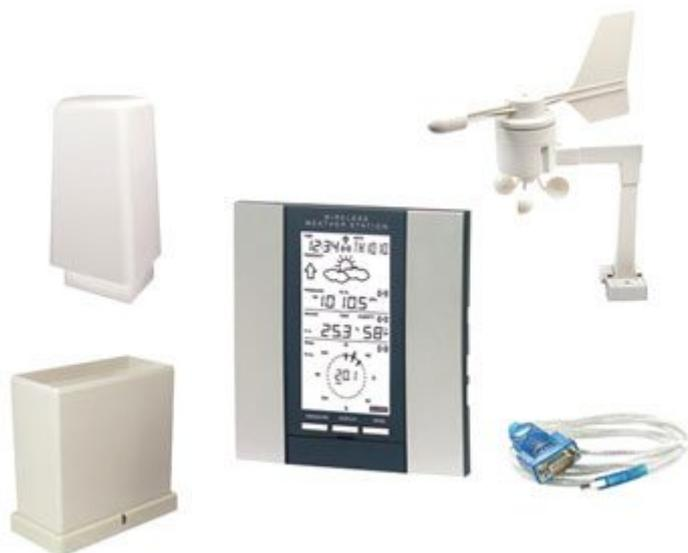
Stazione meteo professionale completa di pluviometro, anemometro, direzione del vento, temperatura, umidità, barometro, orologio radiocontrollato. I sensori esterni trasmettono i dati alla base via radio (433 MHz). La base è interfacciabile ad un PC tramite cavo seriale/USB (software incluso).
