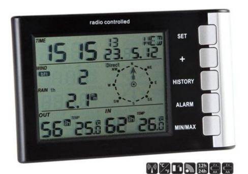
Elegante stazione meteo wireless con frequenza di funzionamento a 868 MHz. Completa di pluviometro, anemometro, igrometro, sensore per la temperatura, sensore per la direzione del vento. Orologio radiocontrollato (DCF77) con aggiornamento automatico dell'ora, modalità di visualizzazione dell'ora: 12h/24h, sveglia con snooze, calendario perpetuo. Portata 100 metri circa. Alimentazione a batterie.
