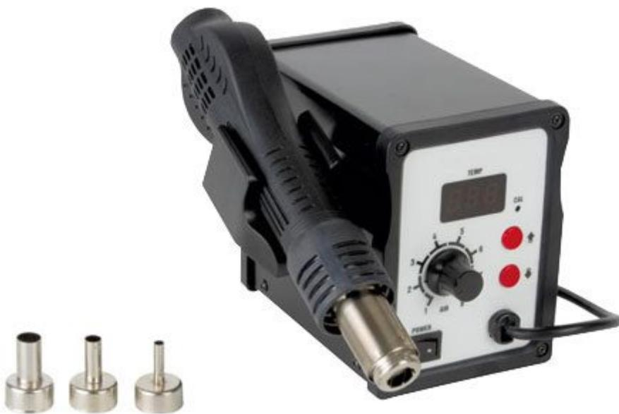
Stazione saldante/dissaldante ad aria calda per componenti SMD, con regolazione del flusso d'aria e della temperatura. Riscaldamento rapido, compatibile con vari tipi di ugelli d'aria. Alimentazione: 230 Vac 50 Hz, consumo: 700 W, range di temperatura: da 100°C a 450°C, portata d'aria: 120 litri / min (max.), dimensioni: 151 x 100 x 153 mm, peso: 1,305 kg. Fornito con tre tipi di ugelli d'aria e portasaldatore.
