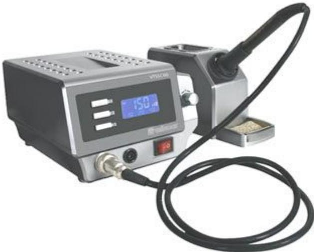
Stazione saldante con elemento riscaldante in ceramica e display LCD con indicazione della temperatura impostata e della temperatura reale. Impostazione manuale della temperatura. 3 livelli di temperatura programmabili. Interruttore di ON/OFF. Stilo funzionante a 24 V.
