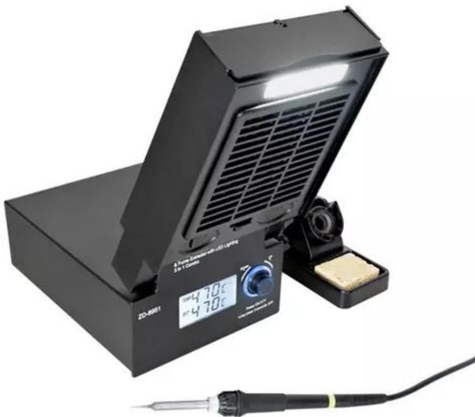
Stazione saldante con elemento riscaldante in ceramica con sensore PTC, aspiratore di fumo e luce a LED. Dispone di display LCD retroilluminato che consente di leggere rapidamente, sia la temperatura impostata che quella reale. Grazie alla funzione di riscaldamento rapido è in grado di raggiungere una temperatura di 400°C in meno di un minuto. Portata d'aria fino a 1m<sup>3</sup> al minuto.
