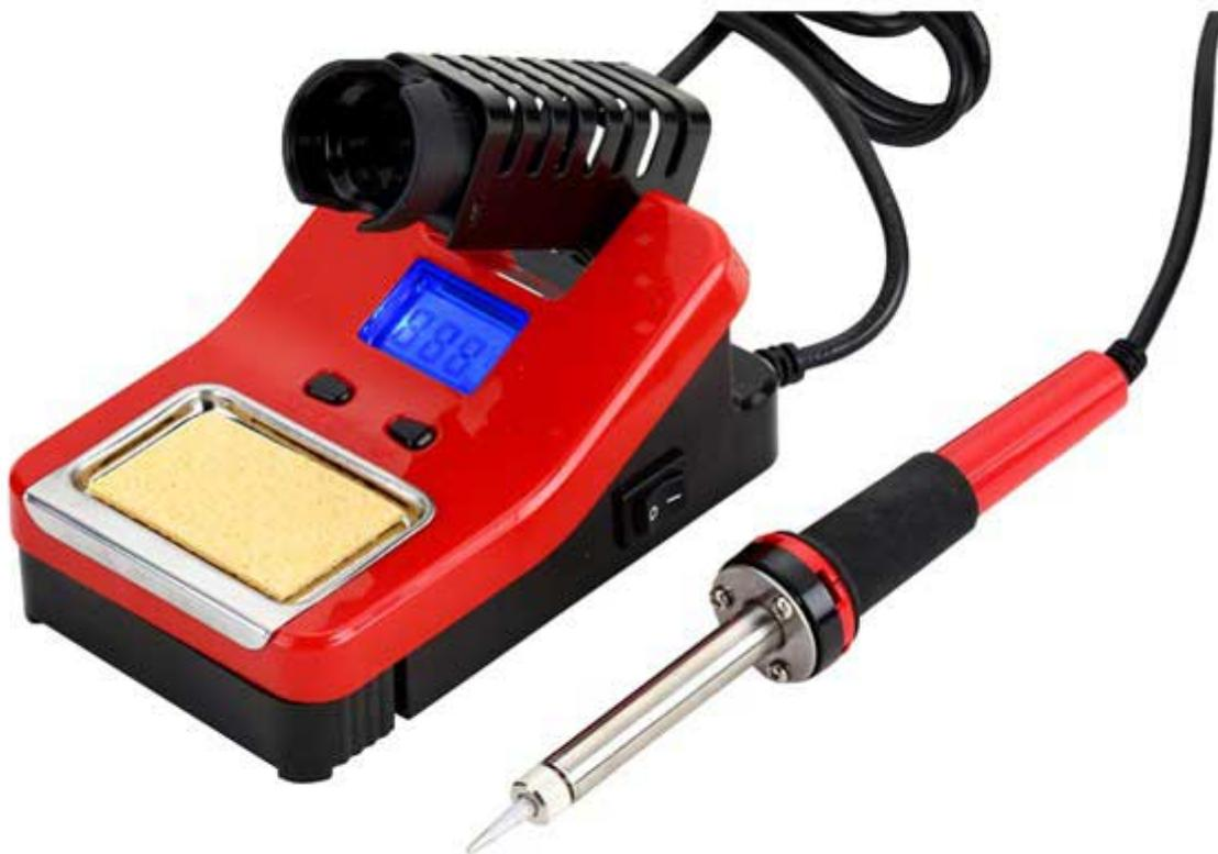
La stazione saldante con display offre una regolazione digitale della temperatura che vi consente di lavorare con precisione. Con una regolazione da 160°C a 480°C, questo saldatore vi dà il controllo completo sulla temperatura per adattarla alle esigenze specifiche del vostro lavoro, garantendo risultati impeccabili. Il cuore di questa stazione saldante è il suo elemento riscaldante in ceramica da 48 W, che offre una potenza massima per una saldatura efficiente e veloce. Potete contare su
