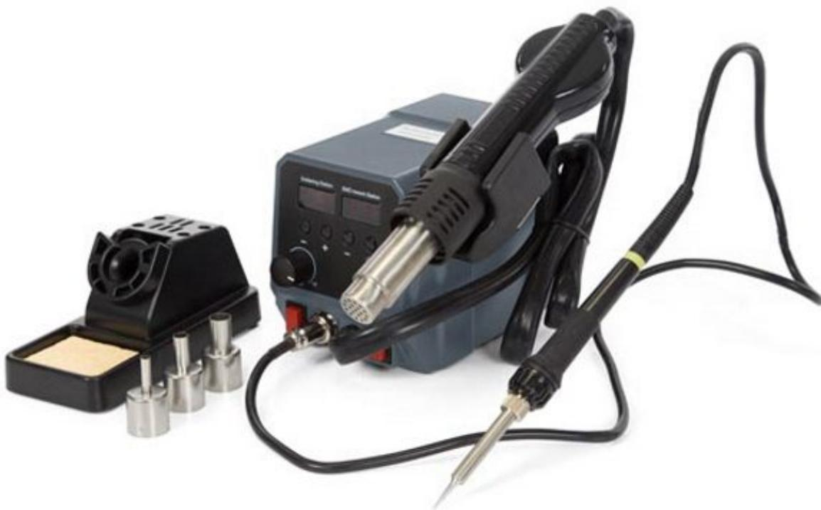
Stazione saldante / dissaldante per componenti SMD con stilo ad aria calda. È dotata di regolazione per la portata del flusso dell'aria e di regolazione della temperatura sia per l'unità saldante che dissaldante. Dispone di doppio display LCD che consente di visualizzare contemporaneamente la temperatura del saldatore e del dissaldatore. Fornita completa di tre tipi di ugelli d'aria e portasaldate.
