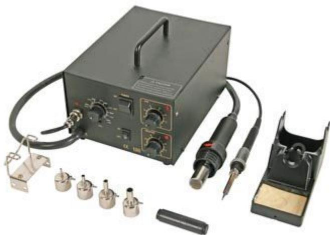
Stazione saldante e dissaldante per componenti SMD, composta da uno stilo ad aria calda e da un saldatore a 24 V. Dotata di elemento riscaldante in ceramica, sensore RTD (sensore di temperatura a resistenza variabile) e sistema di raffreddamento automatico. Possibilità di regolare il flusso dell'aria e la temperatura, fornito con quattro tipi di ugelli d'aria e portasaldatore.
