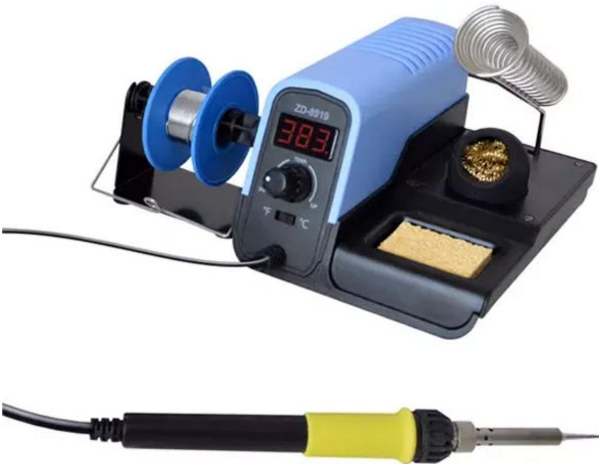
Stazione saldante con regolazione della temperatura da 160°C a 480°C, resistenza con sensore PTC, funzione sleep, display a LED, impostazione della temperatura in °C e °K. La punta è in grado di raggiungere i 400°C in soli 50 secondi. La temperatura impostata viene mantenuta costante anche quando si riscaldano componenti più grandi. La funzione "sleep" riduce il consumo dopo dieci minuti di inattività.
