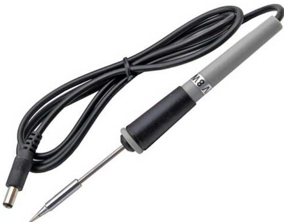
Stilo di ricambio per la mini stazione saldante SS202 (non compresa – vedere prodotti correlati). Lo stilo può anche essere utilizzato come mini saldatore, basta alimentarlo a 12 volt. Dispone di elemento riscaldante in ceramica ed è caratterizzata da un bassissimo consumo energetico, appena 8 watt. Range di temperatura: 100°C-450°C. Utilizzabile anche per dissaldare senza surriscaldare eccessivamente i componenti. Dimensioni (mm): lunghezza totale circa 150, lunghezza cavo 1 metro.
