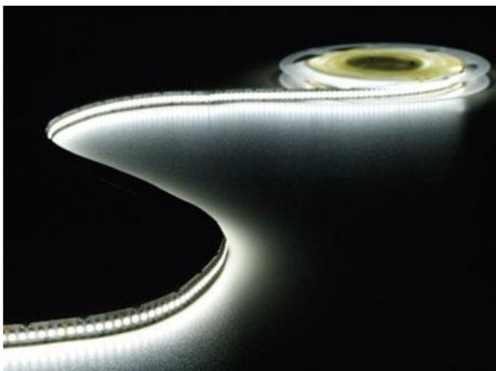
Strip luminoso ad anodo comune contenente 1.200 LED bianchi (tipo 3528) ad alta luminosità, flessibile e dotato di base adesiva. Può essere tagliato ogni 6 LED (2,5 cm). Utilizzabile con il dimmer VM152. Può essere alimentato con PSIN10024, PSIN30024 (non compresi).
