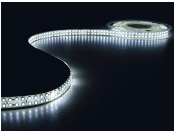
Strip luminoso ad anodo comune contenente 1.200 LED (disposti su 2 file) bianchi ad alta luminosità, flessibile e dotato di base adesiva. Può essere tagliato ogni 12 LED (5 cm). Utilizzabile con il dimmer VM152. Può essere alimentato con PSIN10024, PSIN30024 (non compresi). Lunghezza: 5 metri.
