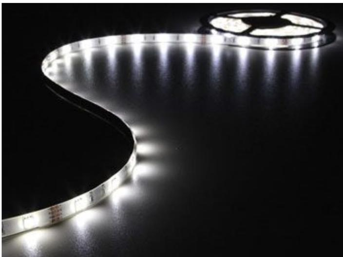
Strip luminoso ad anodo comune contenente 150 LED bianchi (tipo 5050) ad alta luminosità, flessibile e dotato di base adesiva. Può essere tagliato ogni 3 LED (10 cm). Lunghezza: 5 metri. La confezione comprende: lo strip e l'alimentatore di rete.
