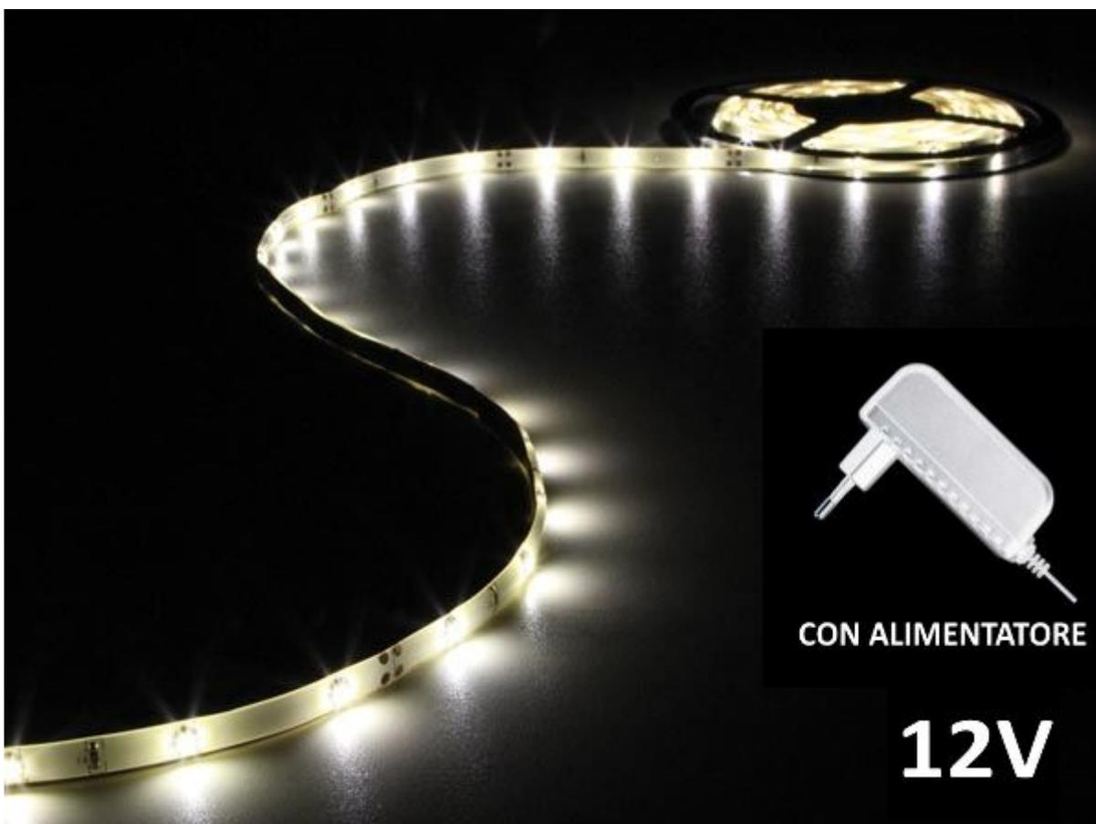
Strip luminoso ad anodo comune contenente 150 LED bianco caldo (tipo 5050) ad alta luminosità, flessibile e dotato di base adesiva. Può essere tagliato ogni 3 LED (10 cm). Lunghezza: 5 metri. La confezione comprende: lo strip e l'alimentatore di rete.
