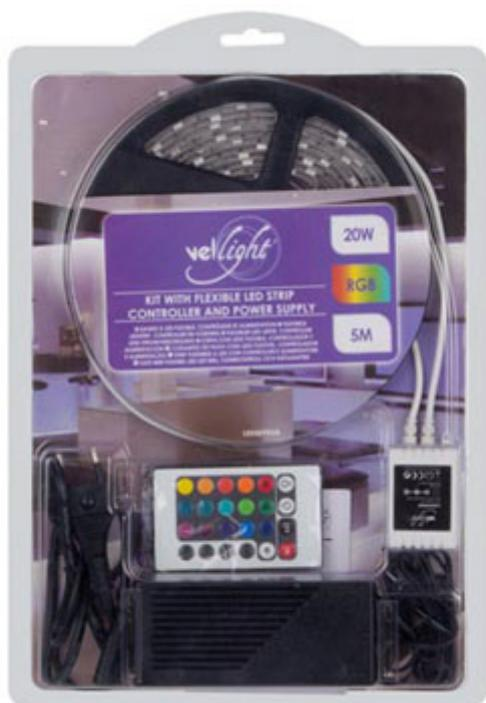
Strip luminoso ad anodo comune contenente 150 LED RGB (tipo 5050) ad alta luminosità, flessibile e dotato di base adesiva. Può essere tagliato ogni 3 LED (10 cm). Lunghezza: 5 metri. La confezione comprende lo strip, l'alimentatore di rete e il radiocomando ad infrarossi.
