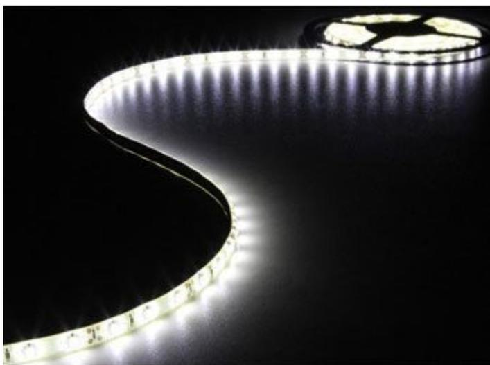
Strip luminoso ad anodo comune contenente 300 LED bianchi (tipo 3528) ad alta luminosità, flessibile e dotato di base adesiva. Può essere tagliato ogni 3 LED (5 cm). Utilizzabile con il dimmer VM152. Può essere alimentato con PSIN06012, PSIN10012, PSIN15012, PSIN30012, LPS04512R e LPS06012R (non compresi). Lunghezza: 5 metri.
