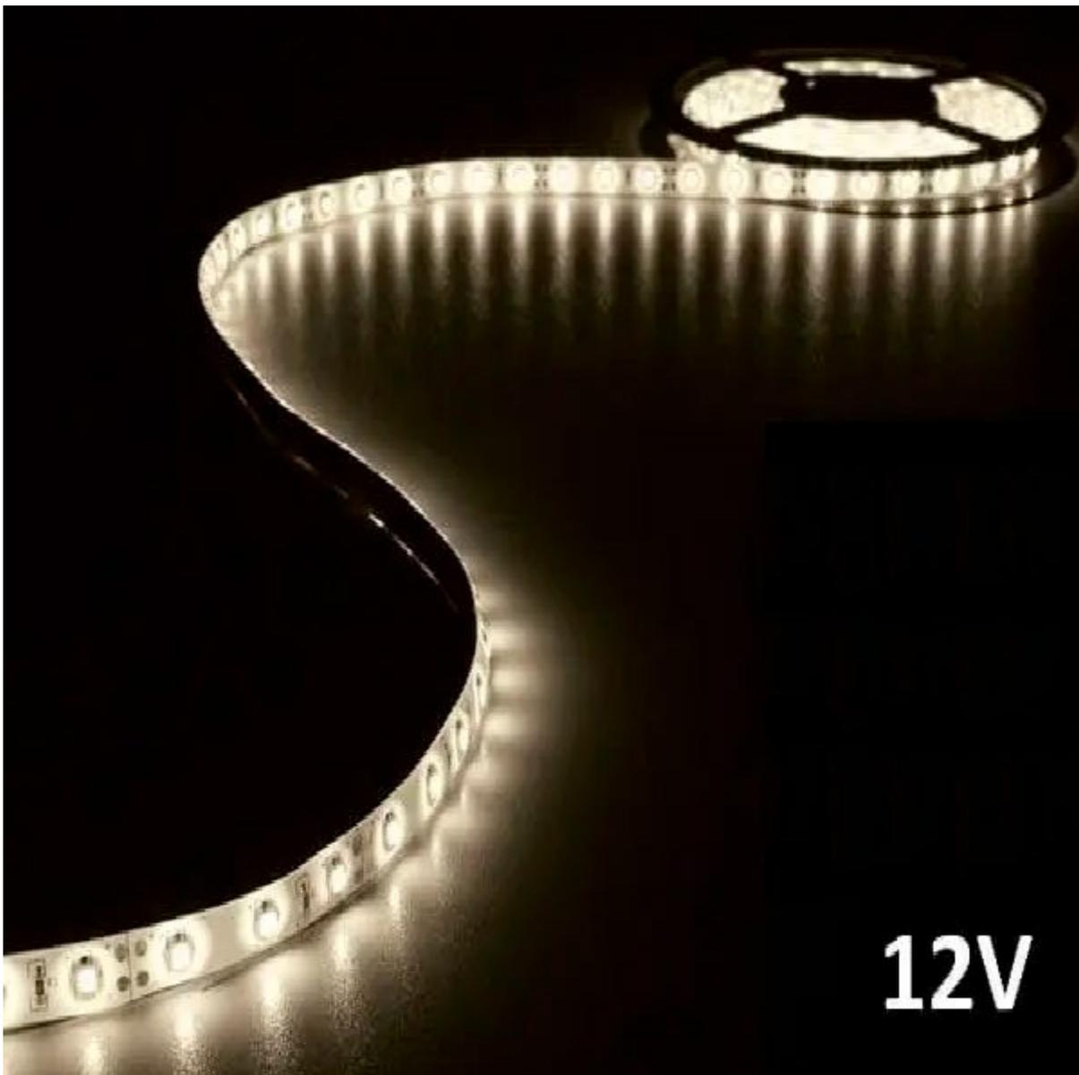
Strip luminoso ad anodo comune contenente 300 LED bianco caldo ad alta luminosità, flessibile e dotato di base adesiva. Angolo di visione: 120°, distanza tra LED: 16,5 mm, lunghezza: 5 metri. Può essere tagliato ogni 3 LED (5 cm). Da utilizzare all'interno.
