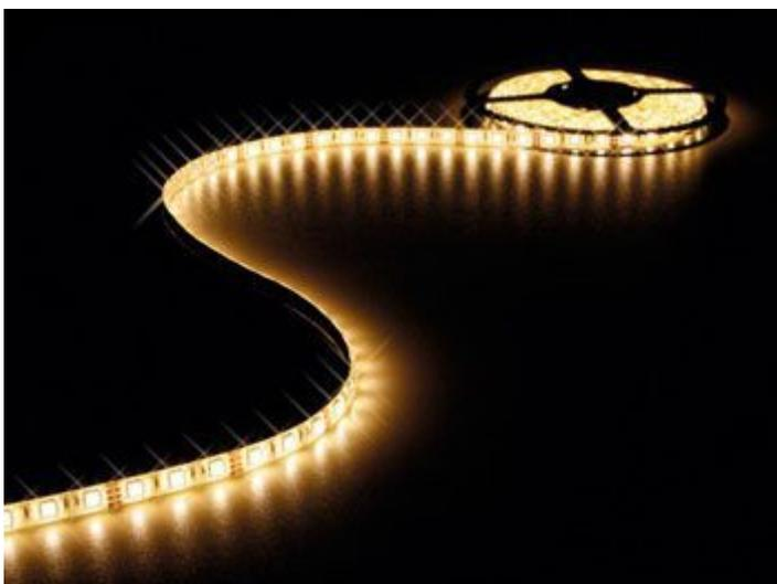
Strip luminoso ad anodo comune contenente 300 LED a luce bianco caldo (tipo 5050) ad alta luminosità, flessibile e dotato di base adesiva. Può essere tagliato ogni 3 LED (5 cm). Utilizzabile con il dimmer VM152. Può essere alimentato con PSIN06012, PSIN10012, PSIN15012, PSIN30012, LPS04512R e LPS06012R (non compresi). Lunghezza: 5 metri.
