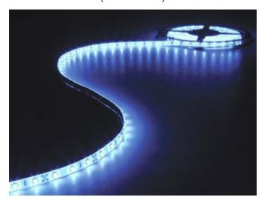
Strip luminoso ad anodo comune contenente 300 LED blu (tipo 3528) ad alta luminosità, flessibile e dotato di base adesiva. Può essere tagliato ogni 3 LED (5 cm). Utilizzabile con il dimmer VM152. Può essere alimentato con PSIN06012, PSIN10012, PSIN15012, PSIN30012, LPS04512R e LPS06012R (non compresi). Lunghezza: 5 metri.
