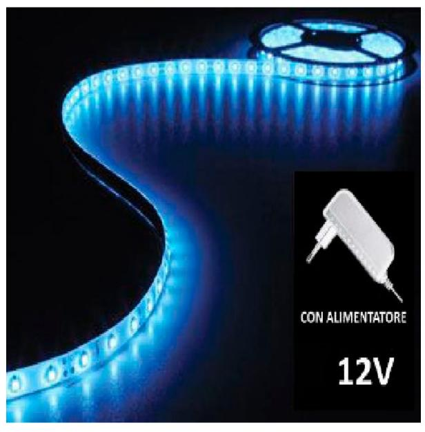
Strip luminoso ad anodo comune contenente 300 LED blu (tipo 3528) ad alta luminosità, flessibile e dotato di base adesiva. Può essere tagliato ogni 3 LED (5 cm). Lunghezza: 5 metri. La confezione comprende: lo strip e l'alimentatore di rete.
