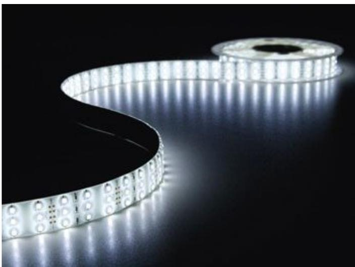
Strip luminoso ad anodo comune contenente 900 LED (disposti su 3 file) bianchi ad alta luminosità, flessibile e dotato di base adesiva. Può essere tagliato ogni 9 LED (5 cm). Utilizzabile con il dimmer VM152. Può essere alimentato con PSIN10012, PSIN15012, PSIN30012 (non compresi). Lunghezza: 5 metri.
