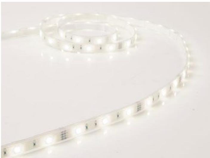
Strip luminoso ad anodo comune contenente 150 LED bianchi ad alta luminosità, resistente alle intemperie (IP68), flessibile e dotato di base adesiva. Distanza tra LED 33 mm. Può essere tagliato ogni 3 LED. Utilizzabile con il modulo dimmer 8220-VM152. Può essere alimentato con PSIN06012, PSIN10012, PSIN15012 e PSIN30012. Lunghezza: 5 metri.
