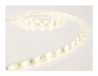
Strip luminoso ad anodo comune contenente 150 LED bianchi ad alta luminosità, resistente alle intemperie (IP68), flessibile e dotato di base adesiva. Distanza tra LED 33 mm. Può essere tagliato ogni 3 LED. Utilizzabile con il modulo dimmer 8220-VM152. Può essere alimentato con PSIN06012, PSIN10012, PSIN15012 e PSIN30012. Lunghezza: 5 metri.
