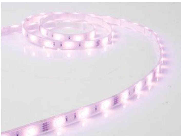
Strip luminoso ad anodo comune contenente 150 LED RGB ad alta luminosità, resistente alle intemperie (IP68), flessibile e dotato di base adesiva. Distanza tra LED 33 mm. Può essere tagliato ogni 6 LED (10 cm). Utilizzabile con il controller K8088, VM146, VM151, CHLSC1 e i moduli dimmer VM161 e VM162. Può essere alimentato con PSIN06012, PSIN10012, PSIN15012 e PSIN30012. Lunghezza: 5 metri.
