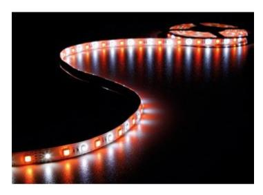
Strip luminoso ad anodo comune contenente 150 LED RGB (tipo 5050) ad alta luminosità + 150 LED bianchi ad alta luminosità (tipo 3528), flessibile e dotato di base adesiva. Distanza tra LED 16,5 mm. Può essere tagliato ogni 6 LED (10 cm). Utilizzabile con il controller CHLS16C (non compreso). Può essere alimentato con PSIN06012, PSIN10012, PSIN15012, PSIN30012, LPS04512R e LPS06012R . Lunghezza: 5 metri.
