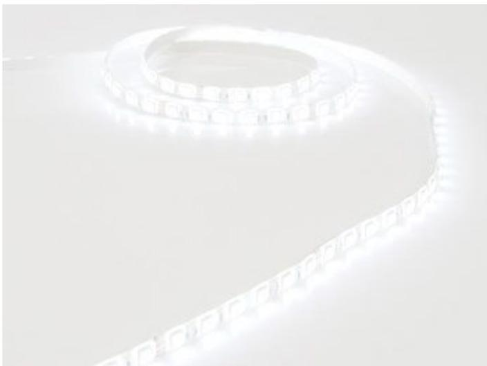
Strip luminoso ad anodo comune contenente 300 LED bianchi ad alta luminosità, resistente alle intemperie (IP68), flessibile e dotato di base adesiva. Distanza tra LED 16,5 mm. Può essere tagliato ogni 6 LED (10 cm). Utilizzabile con il modulo dimmer 8220-VM152. Può essere alimentato con PSIN10024 e PSIN30024. Lunghezza: 5 metri.
