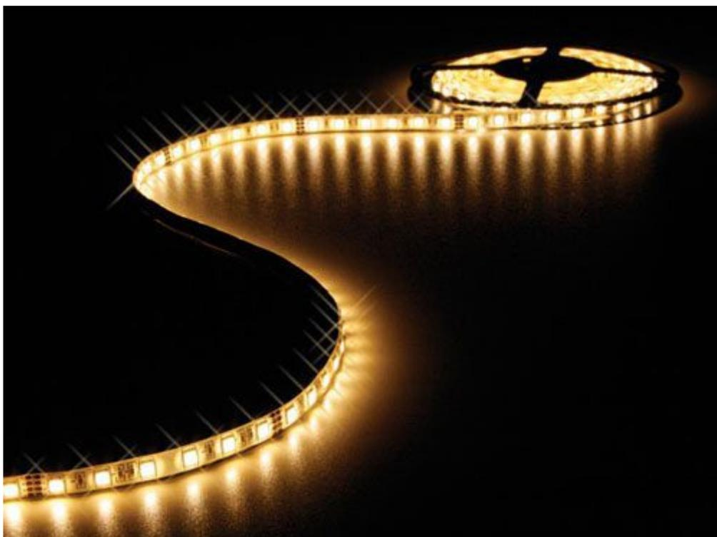
Strip luminoso ad anodo comune contenente 300 LED (tipo 5050) bianchi ad alta luminosità, resistente alle intemperie (IP61), flessibile e dotato di base adesiva. Distanza tra LED 16,5 mm. Può essere tagliato ogni 6 LED (10 cm). Utilizzabile con il modulo dimmer 8220-VM152. Può essere alimentato con PSIN10024 e PSIN30024. Lunghezza: 5 metri.
